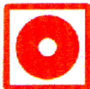
pulsador de alarma
