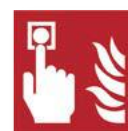
Point d'alarme incendie
