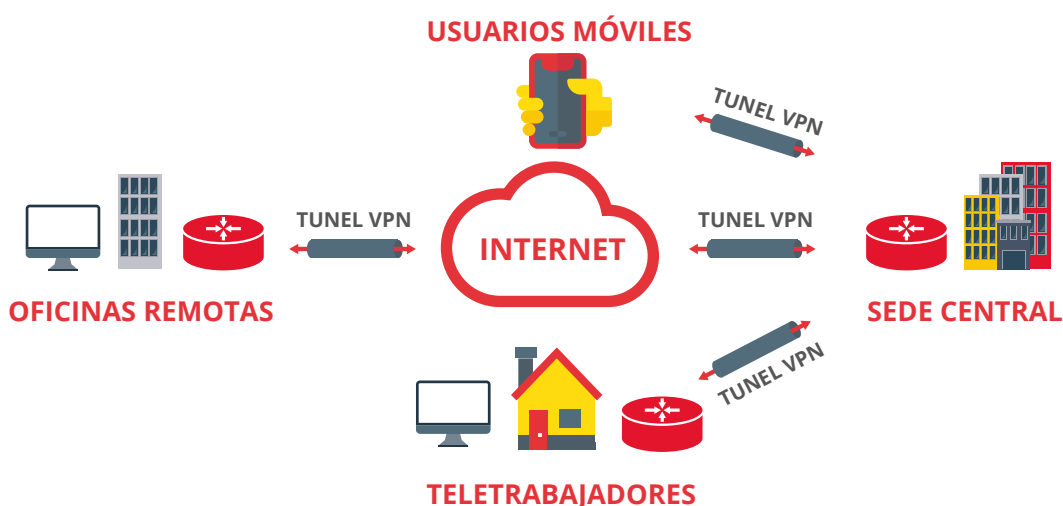
Ilustración 1 Estructura de una VPN para una empresa
