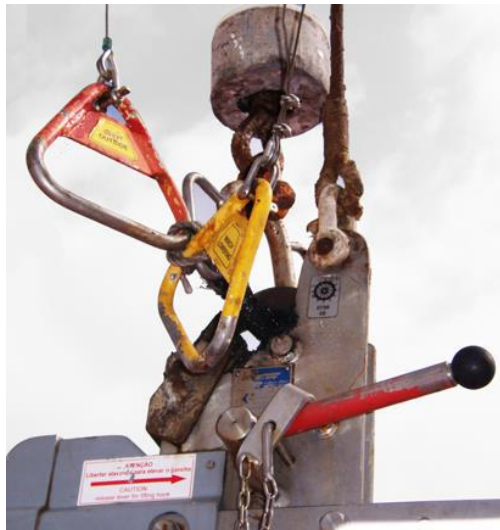
Figura 12 - Mecanismo de disparo da embarcação de salvamento (Navio Ro-Ro “Lobo Marinho” Funchal)
