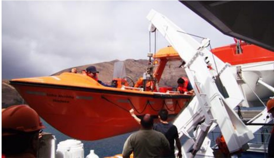
Figura 11 - Embarcação de salvamento rápida estivada no turco (Navio Ro-Ro “Lobo Marinho” Funchal)
