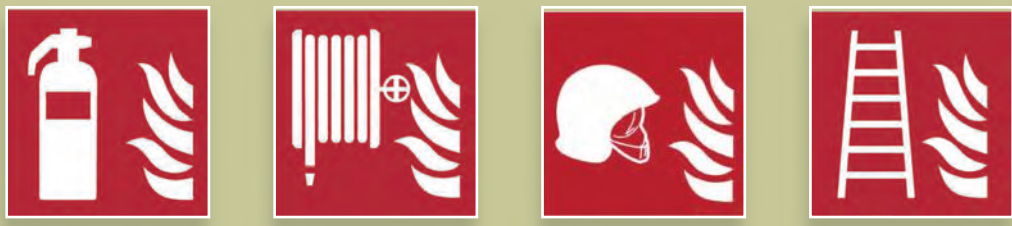
Extincteur d'incendie Robinet d'incendie armé Ensemble d'équipements de lutte contre l'incendie Échelle d'incendie
