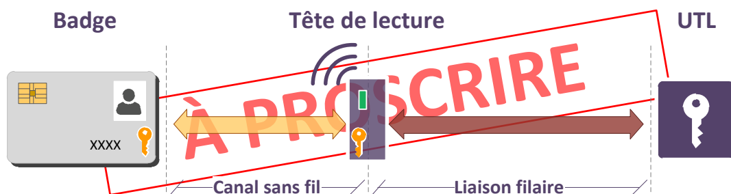
FIGURE 6.5 – Configuration type n°4 : Badge sécurisé, avec liaison filaire non chiffrée
