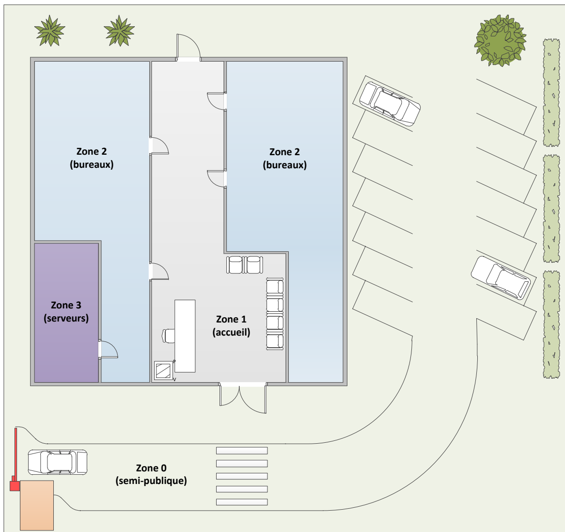
FIGURE 3.1 – Exemple de découpage d'un site en zones associées à des niveaux de protection attendus
