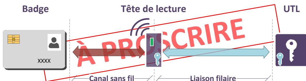
FIGURE 6.4 – Configuration type n°3 : Badge non sécurisé, avec chiffrement filaire seulement
