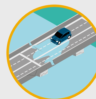
3 Erosión de márgenes y apoyos
