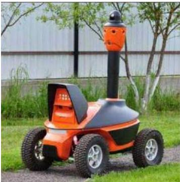
Um robô de monitoramento que move-se guiado via satélite ou por controle remoto em áreas pré-programadas
