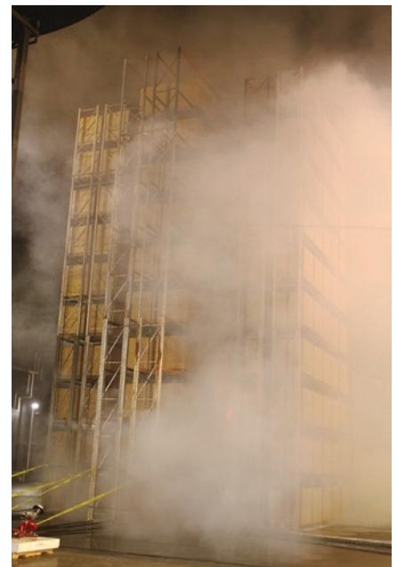
**TESTANDO, TESTANDO** Várias configurações de testes no projeto da FM Global mostraram que utilizando sprinklers com orifícios e taxas de vazão maiores, seria possível reduzir muito o número de sprinklers em estantes necessários numa instalação – assim como o custo do sistema.
