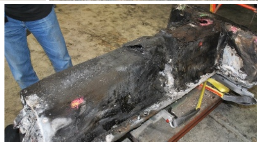
El Chevy Volt luego de la prueba de impacto lateral en 2011, y luego del incendio. Arriba, la batería de lítio-ion del auto.
