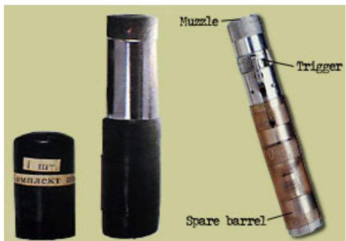
Relíquia soviética da Guerra Fria, um baton dispara como uma arma de único tiro.
