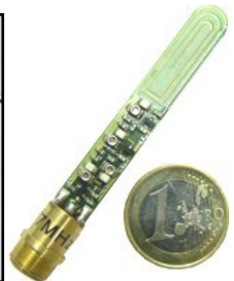
A comparação com a moeda permite que se tenha idéia da miniaturização dos circuitos transmissores.
