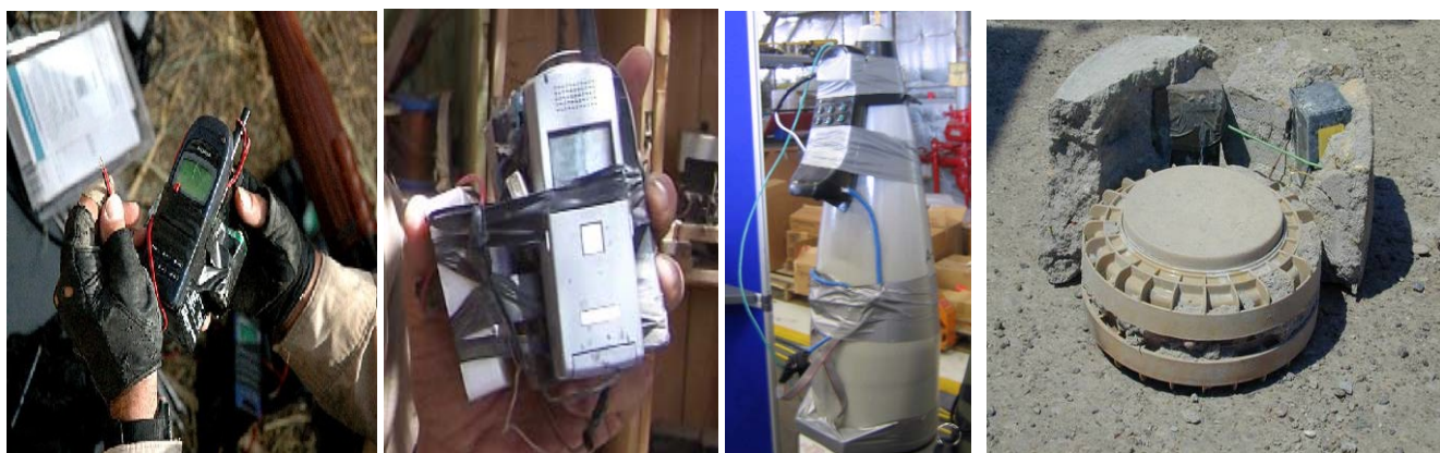
No Iraque, artefatos de diferentes tamanhos com explosivos militares, granadas de artilharia, bombas de aviação e minas terrestres são preparados para detonar a partir da adaptação de telefones celulares e comandos de rádio comerciais.
