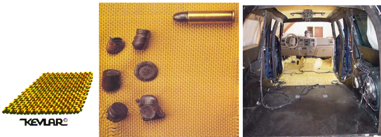
Uma amostra da capacidade de retenção de tiros de um laminado de aramida e sua instalação em painéis no interior dos os veículos.
