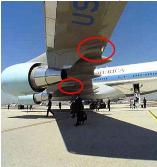
O Air Force 1 também possui contra-medidas protegendo o escapamento dos motores de mísseis guiados por infra-vermelho (esq.). À direita, uma moderna aeronave de fabricação brasileira dispara seus chamarizes incandescentes ("flares") que podem desviar a guiagem pelo calor (infra-vermelha) da maioria dos MANPADS.
