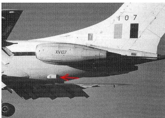
Aeronaves de transporte britânicas começaram a ser equipadas com equipamentos de contra-medidas contra mísseis em função da ameaça dos mísseis anti-aéreos nas mãos dos terroristas do IRA.
